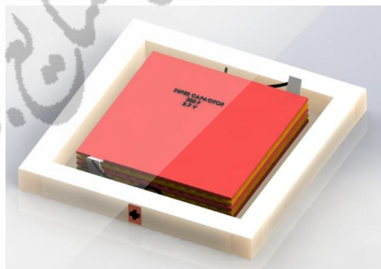
شکل شماره شش - برش سطحی یک سرامیک ( سنگ کف ) مجهز به ابرخازن
